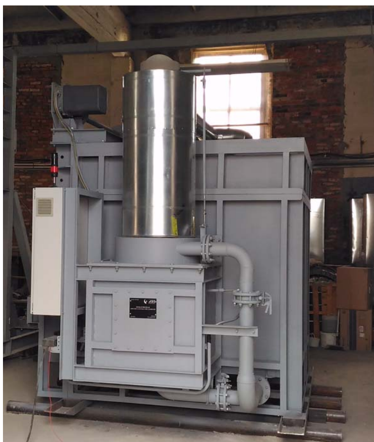
Фото 16. Кузнечная печь АНХ-КП-1,2-0,9-0,6-1300-2,0-600-500 (вид со стороны рекуператора)
