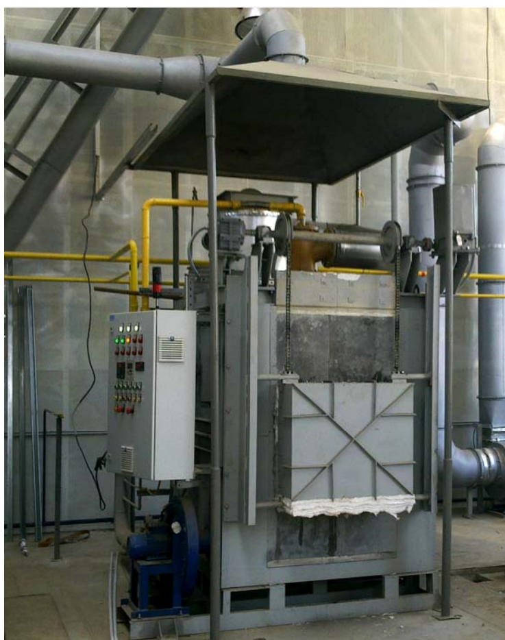
Фото 3. Кузнечная печь со сводовой горелкой и рекуператором АНХ-КП-0,8-0,6-0,8-1250-0,4-500-500.
