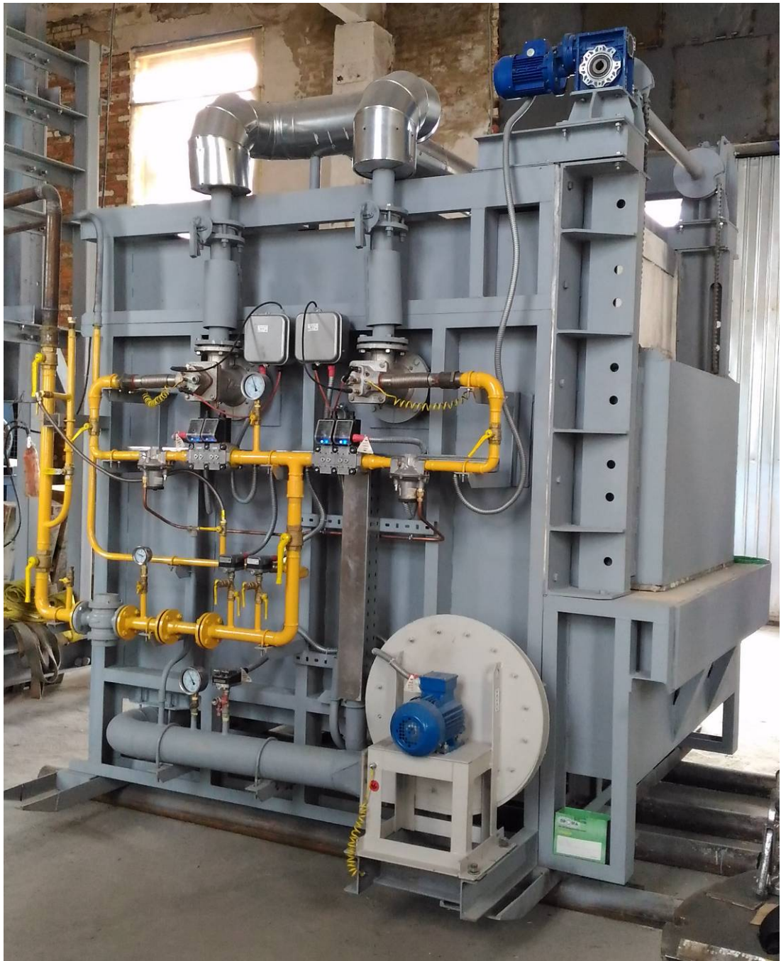
Фото 1а. Кузнечная печь АНХ-КП-1,2-0,9-0,6-1300-2,0-600-500 в сборочном цеху, готовая к отгрузке Заказчику.
