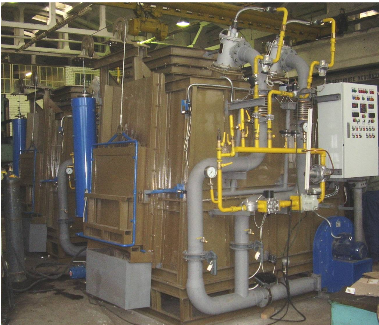
Фото 1. Кузнечные печи на заводе изготовителе перед отправкой потребителю
